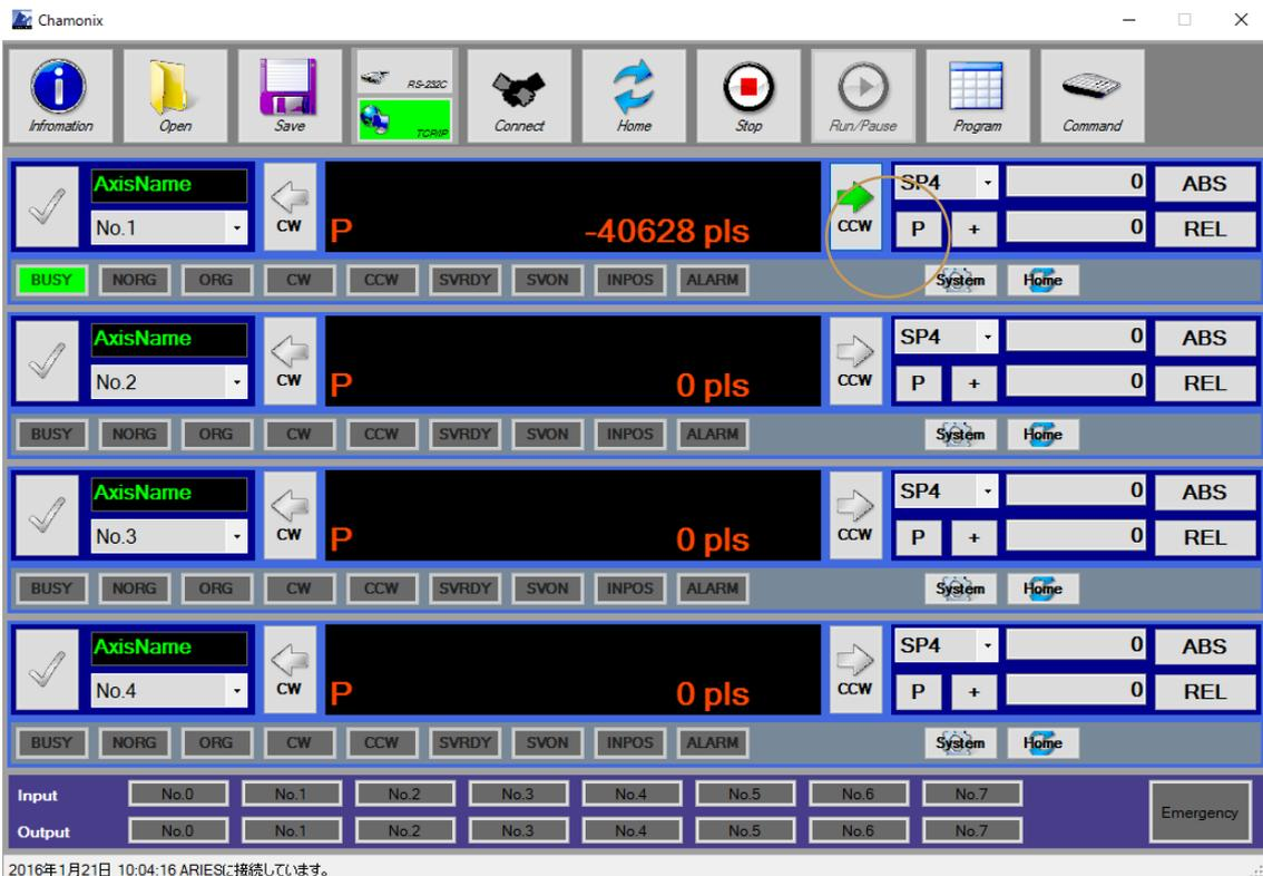
各軸の CW ボタンを押下すると、その間 CW 方向へ移動します。
