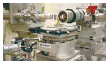
回転芯がぶれない回転ステージ 技術力を駆使した摺り合せ方式採用の回転ステージ。 偏芯1 \mu m以下で、コストダウン対応。
